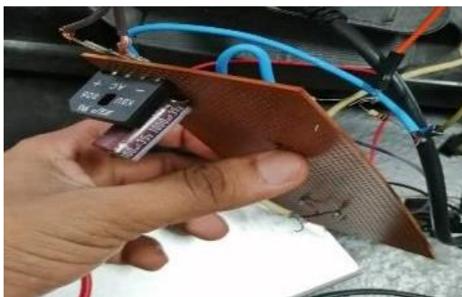
Fig. 4: KBU 808 Rectifier, 1000 µF capacitor
